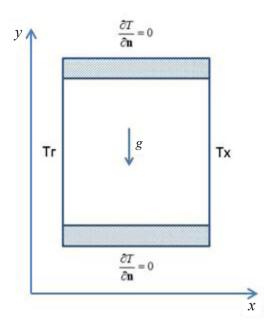
Фиг. 1. Расчетная область. Слева горячая стенка с температурой Тг, справа – холодная с температурой Тх.
