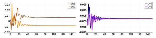
**Фиг. 7.** Распределения компонент скорости в точках 1 и 2 для  $Gr = 10^8$ , сетка  $40 \times 40$ .
