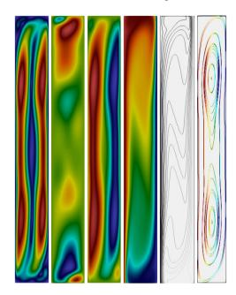
Фиг. 11. Картина осредненного течения. Модуль скорости, Ux, Uy, T, изотермы, линии тока.
